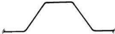
شکل ۳۴. تقویت فولاد عرضی تیرچه در تکیه گاه
