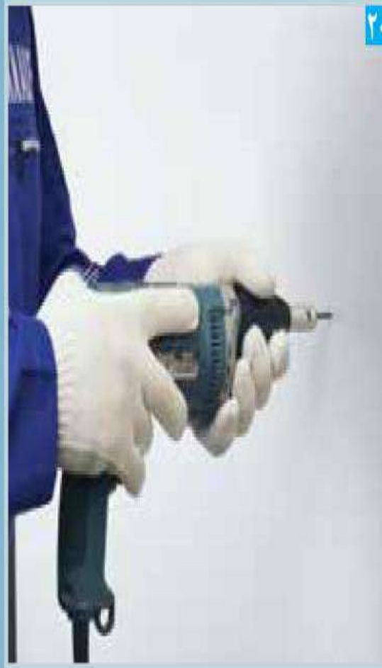
نحوه صحیح در دست گرفتن پیچ زن (به صورت عمود بر پنل)
