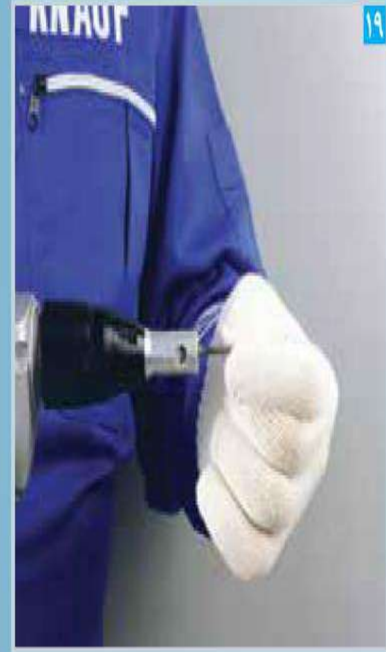
برای نصب پنل ها از پیچ مخصوص و دستگاه پیچ زن استفاده می شود
