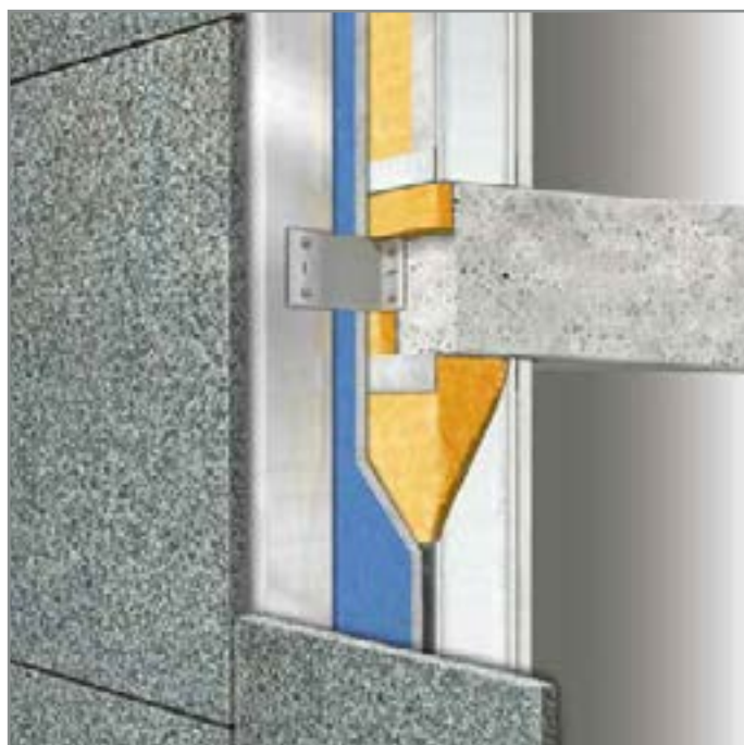
دیوار خارجی گاردکس با نمای سرامیک
